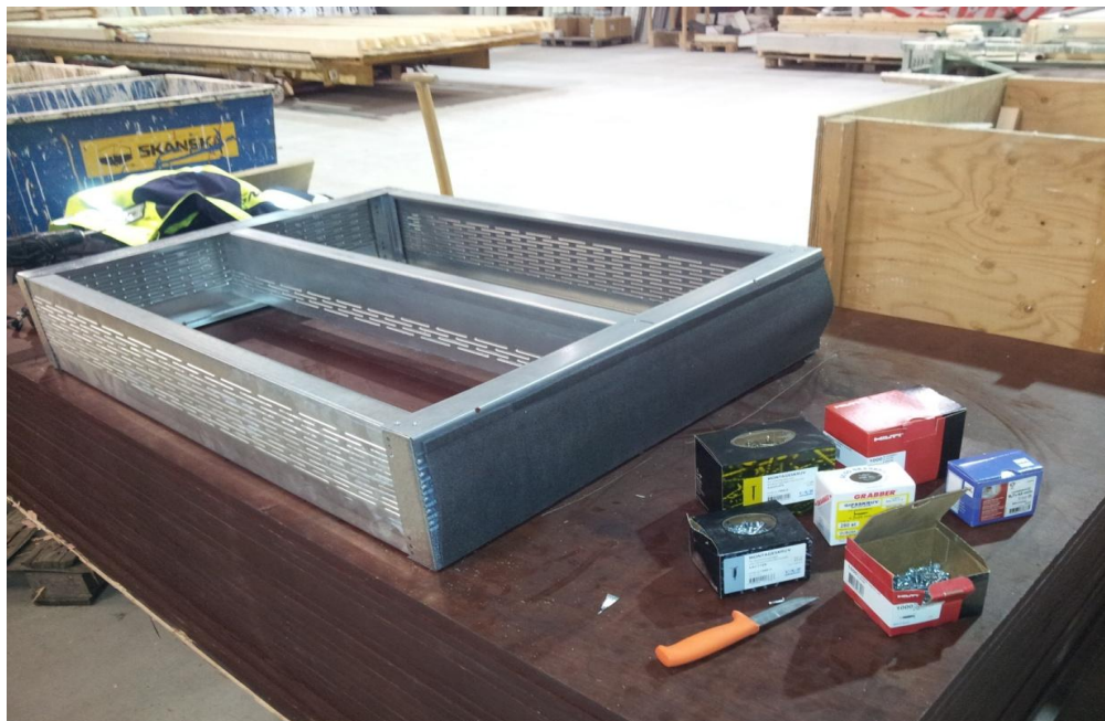
Figur 7. Montageskruvar med platt huvud för stål/stål testas och utvärderas.
