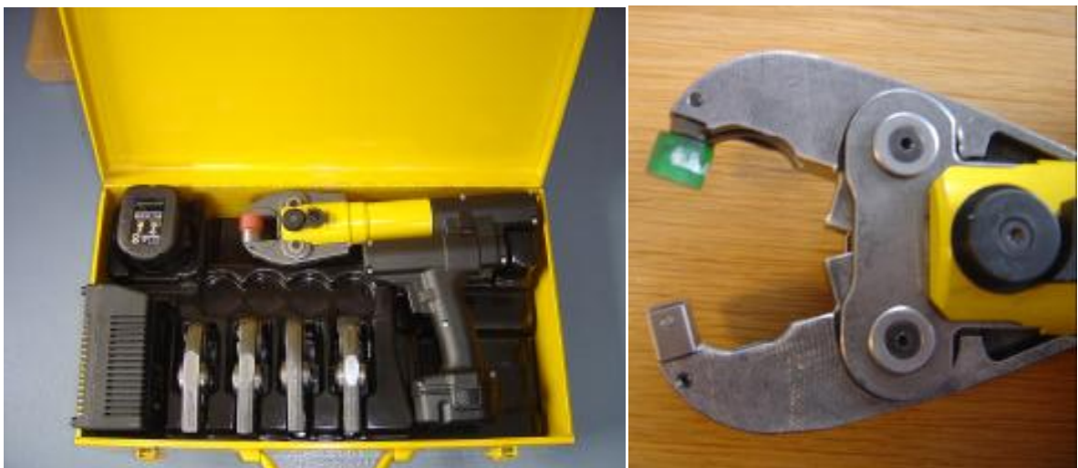
Figur 11. Lindabs Clinchmaster MX4 med tillbehör i form av olika käftar för stål 2x(0,5-2,0).
