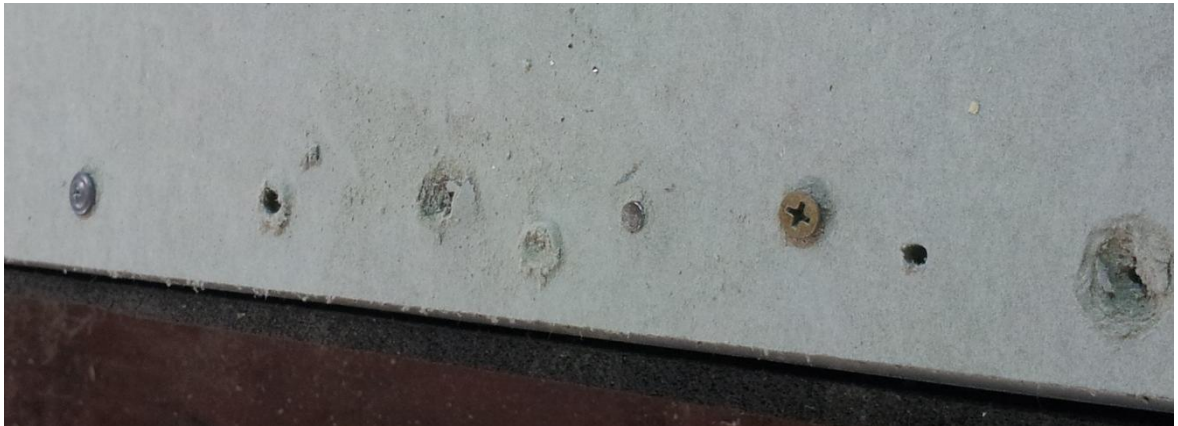
Figur 19. Skruvning med bandad borrhållsskruv misslyckades för minerit.
