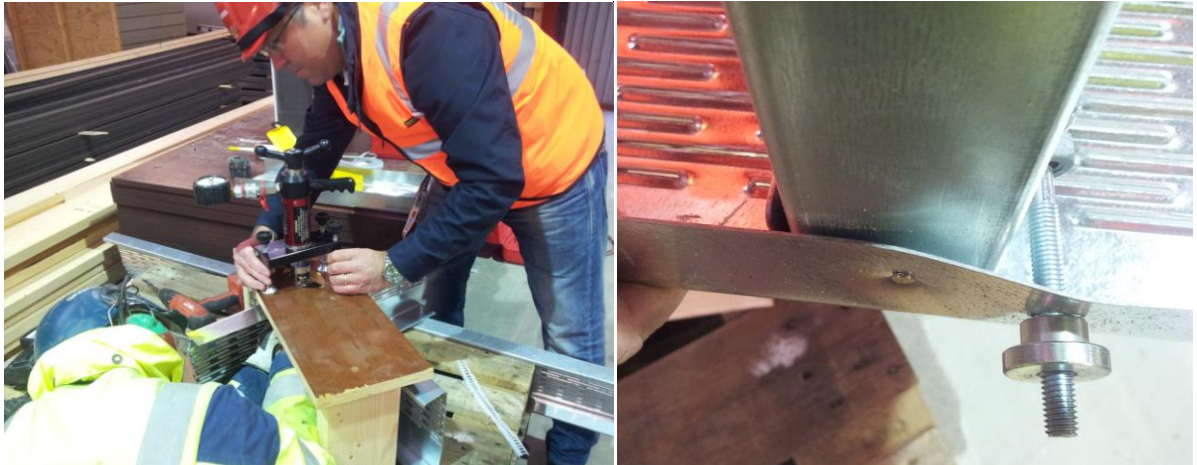
Figur 15. Tillsammans med Tekniker från Ergofast provdras ett förband av stål/stål men en spik. Testet visar bl.a. att vid ståltjocklek på 1,0mm så böjer sig skenan innan spiken släpper.
