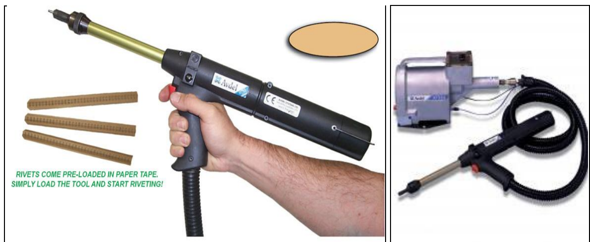
Figur 14. Magasinnitssystem från Ejot&Avdel effektiviserar nitningsprocessen.
