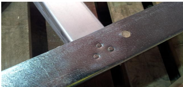
Figur 6. Spikning av stålreglar till skenor testas och provdras i samarbete med Ergofast.
