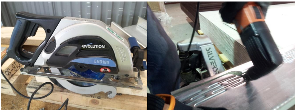
Figur 29. Till vänster: Evolutions cirkelsåg har handtaget placerat rakt bakom sågen. Till höger: Nibblern fastnar lätt när perforeringen ska passeras.
