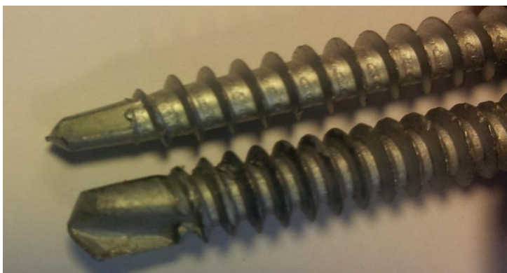
Figur 25. Temas fixeringsskruv (överst) upplevs spetsigare än Kartros i sitt utförande.
